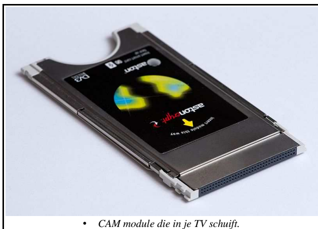
• CAM module die in je TV schuift.
